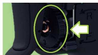
Răsuciți sau deșurubați dispozitivul de fixare atunci când apăsați trăgaciul instrumentului.
