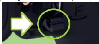
Para desaparafusar, gire a chave seletora para a posição "R".
